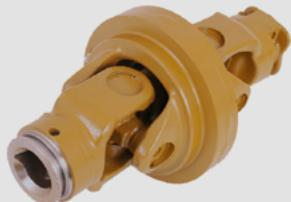
Широкоугольный шарнир устанавливается на карданный вал, обеспечивает его равномерную работу и позволяет карданному валу кратковременно работать при углах до 80 градусов.
