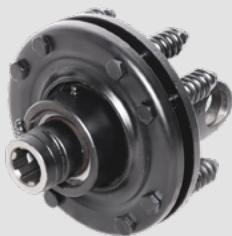
Stosuje się w maszynach rolniczych pracujących ze stałym nadmiarem momentu obrotowego, który należy pokonać bez przerwania przenoszenia momentu obrotowego i ruchu maszyny. Sprzęgło jednokierunkowe cierne przenosi moment obrotowy za pomocą tarcz ciernych umieszczonych między jarzmem kołnierza a piastą sprzęgła.
