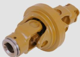
Przegub szerokokątny jest zamontowany na wale napędowym. Zapewnia równomierną pracę i umożliwia chwilową pracę wału napędowego pod kątem do 80 stopni.
