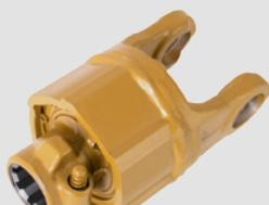
Sprzęgło jednokierunkowe zostało zaprojektowane w celu ochrony przed nadmiernym momentem obrotowym spowodowanym bezwładnością maszyny rolniczej, który występuje podczas hamowania oraz podczas całkowitego zatrzymania maszyny. Sprzęgło jednokierunkowe przenosi moment obrotowy tylko w jednym kierunku dzięki sprężeniu zapadek z obudową sprzęgła. W przeciwnym kierunku sprzęgło obraca się swobodnie. Standardowy kierunek sprzęgła jednokierunkowego jest zgodny z ruchem wskaźówek zegara.
