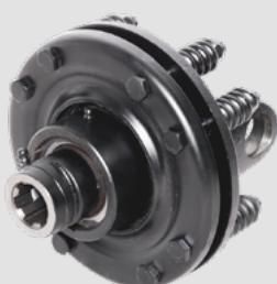
Фрикційно-обгінна муфта - це комбінація обгінної муфти та муфти з фрикційними дисками для обмеження можливих перевантажень при роботі сільгоспмашини шляхом усунення позитивних та негативних піков крутного моменту.
