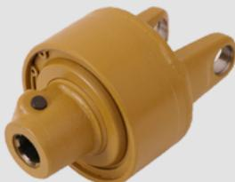
При перегрузке автоматическая муфта отключается, не вызывая износа (например, в храповых, фрикционных или срезных муфтах). При преодолении сопротивления сцепление автоматически включается, передавая крутящий момент.
