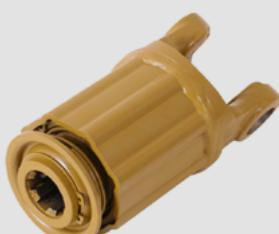
В радиально-штифтовых муфтах подпружиненные штифты входят в зацепление с соответствующими пазами в корпусе. Сила сжатия пружины в муфте определяет передаваемый крутящий момент.
