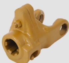
Sprzęgło ze śrubą ścinaną jest przeznaczone do ochrony maszyn rolniczych narażonych na nagłe przeciążenia lub zakleszczenia jednostek roboczych. Przeniesienie momentu obrotowego w sprzegłach ze śrubą ścinaną następuje dzięki śrubie, w wyniku czego piasta i widelec kołnierzowy zaczynają się obracać względem siebie, bez przenoszenia momentu obrotowego.
