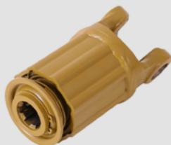
W sprzęgłach przeciążeniowych sworznie sprężynowe sprzągają się z odpowiednimi rowkami w obudowie. Siła ściskająca sprężyny w sprzęgłe określa przenoszony moment obrotowy.
