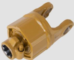
Обгонная муфта предназначена для защиты от превышения крутящего момента, вызванного инерцией сельскохозяйственной машины, возникающей во время торможения или полной остановки трактора. Обгонная муфта передает крутящий момент только в одном направлении за счет зацепления храповиков за корпус муфты, в противоположном направлении муфта свободно проворачивается. Стандартная обгонная муфта - это муфта правого вращения.
